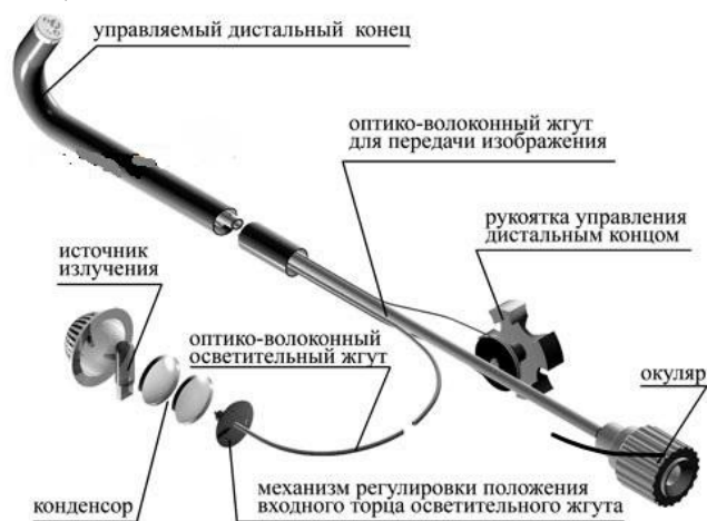
Рис.6. Устройство медицинского эндоскопа
